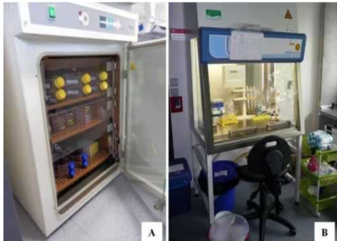
Obr. 2: A) Inkubátor pro kultivaci buněk – zajišťuje teplotu 37 °C, atmosféru s 5 % CO 2 a 90 % vlhkost vzduchu B) Laminární box zajišťující sterilní prostředí pro práci s buněčnými kulturami
