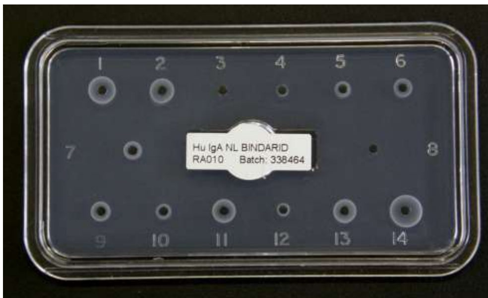
Obr. 1 Destička pro stanovení obsahu protilátek třídy IgA metodou radiální imunodifúze
