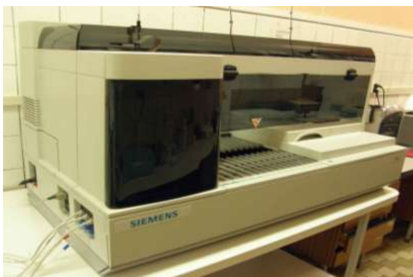
Obr. 2 Automatický nefelometr používaný v imunologické laboratoři k celé řadě vyšetření, včetně stanovení hladin imunoglobulinů
