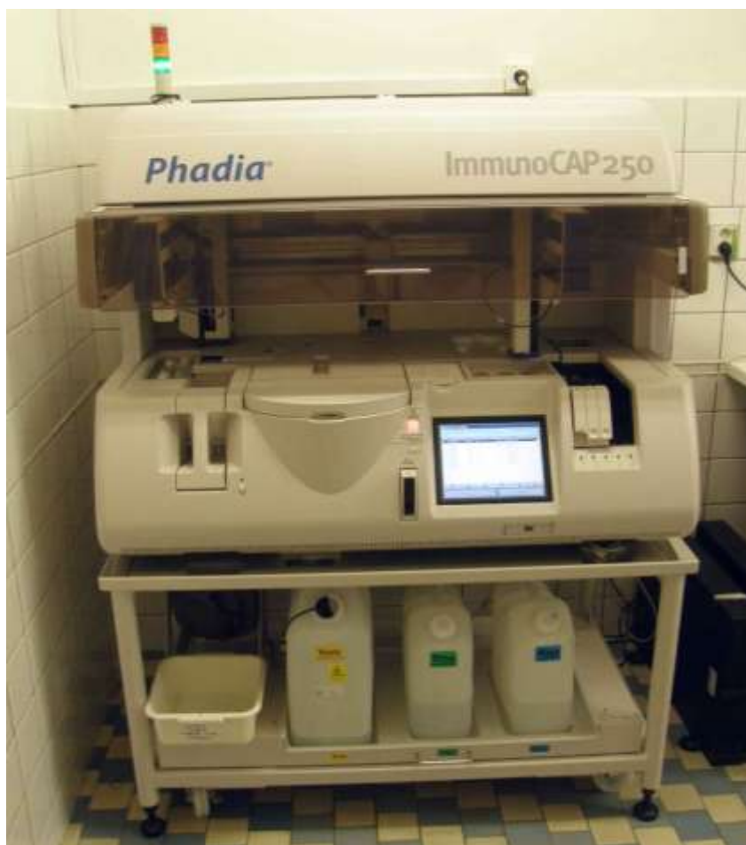
Obr. 1 Automatický přístroj, jehož pomocí se stanovují specifické IgE protilátky v séru.
