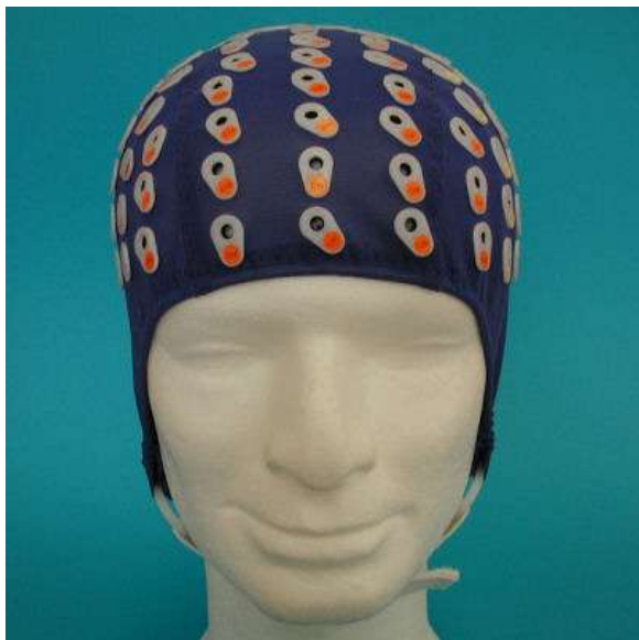
Obr. č. 13: EEG čepice se snímacími elektrodami ( http://www.cbru.helsinki.fi/participation/ )
