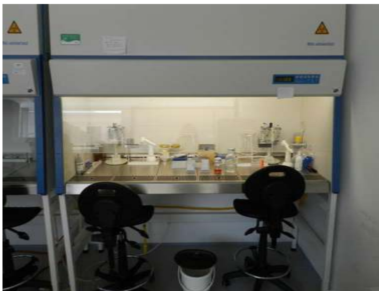
Obr. 1 Pracovní prostor pro práci s buněčnými kulturami (flow box)
