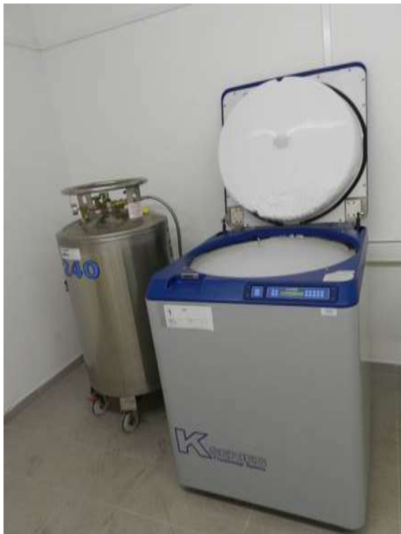
Obr. 1 Systém kryogenního skladování
