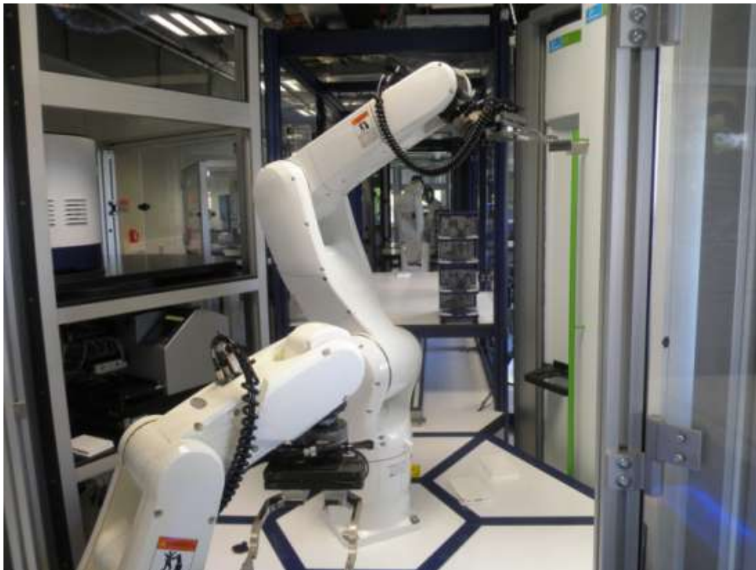
Obr.3 Robot – detail: Detail páteřní dráhy robota s rameny pro manipulaci s panely
